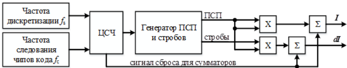
Рисунок 7 – Блок-схема имитационной модели MATLAB/Simulink.
