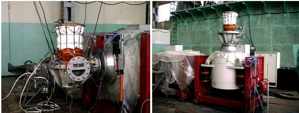
Рисунок 1.4 - Надувное тормозное в сложенном в транспортное положение после проведения вибропрочностных испытаний
