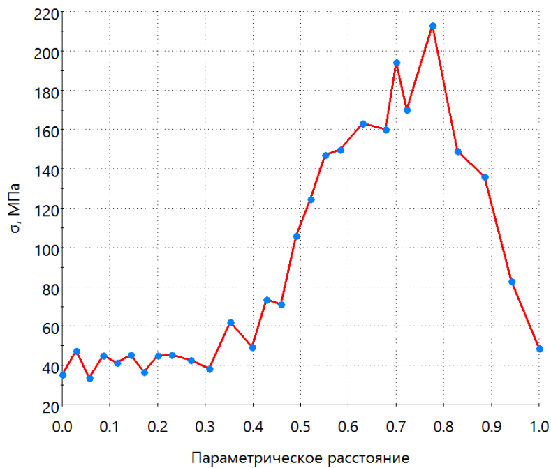
Рис. 9. Распределение СКЗ напряжений по контуру сварной точки
