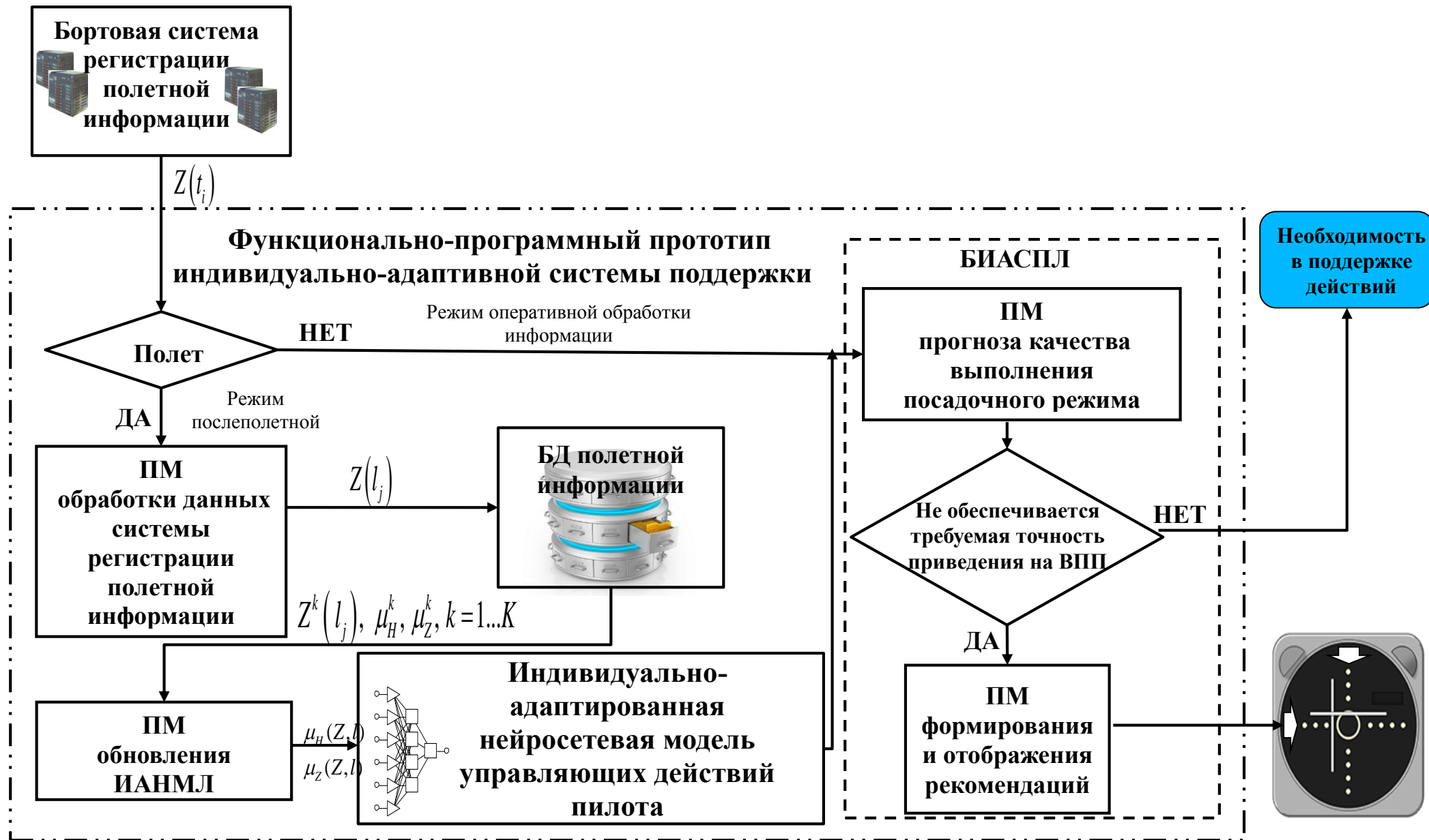
Рис 4.5. Архитектура функционально-программного прототипа индивидуально-адаптированной системы поддержки управляющих действий пилота на этапе посадки
