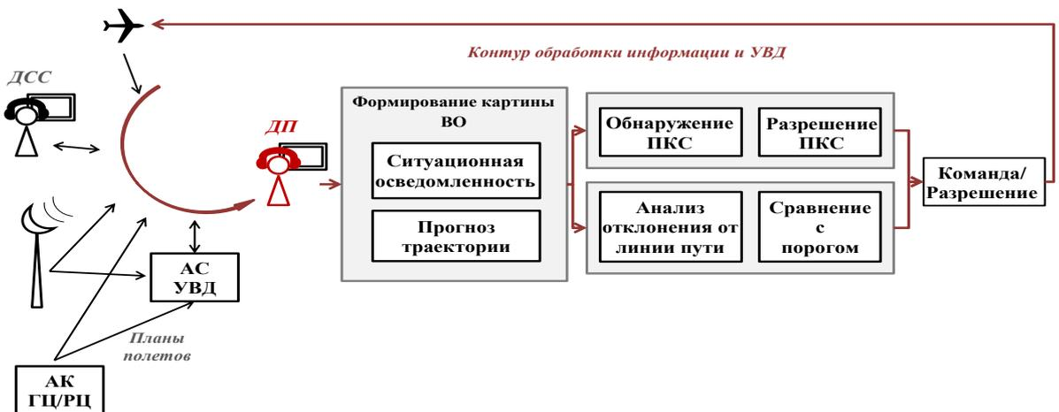
Рисунок 3.9. Схема имитационной модели диспетчерского обслуживания
