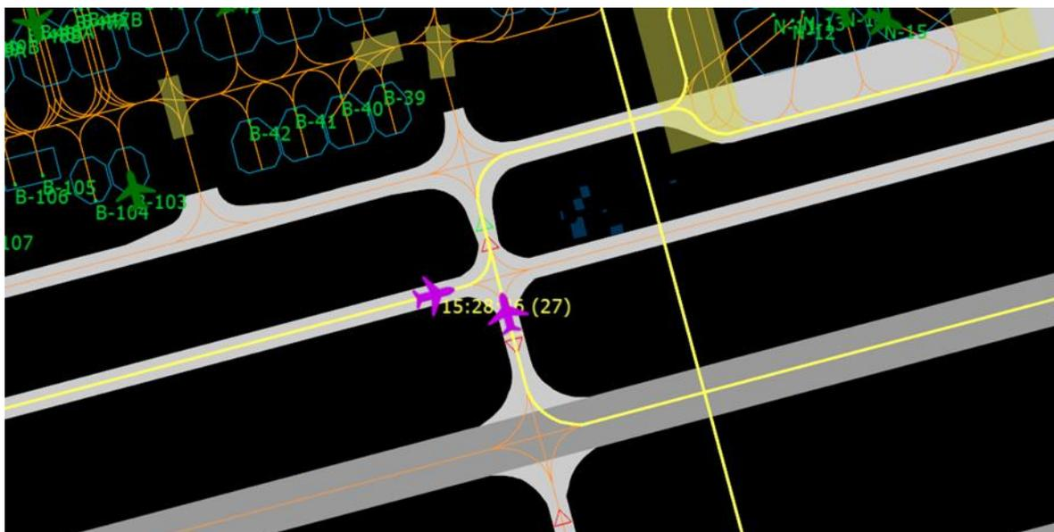
Рисунок 3.13. Конфликт типа «Пересечение на рулежной дорожке»
