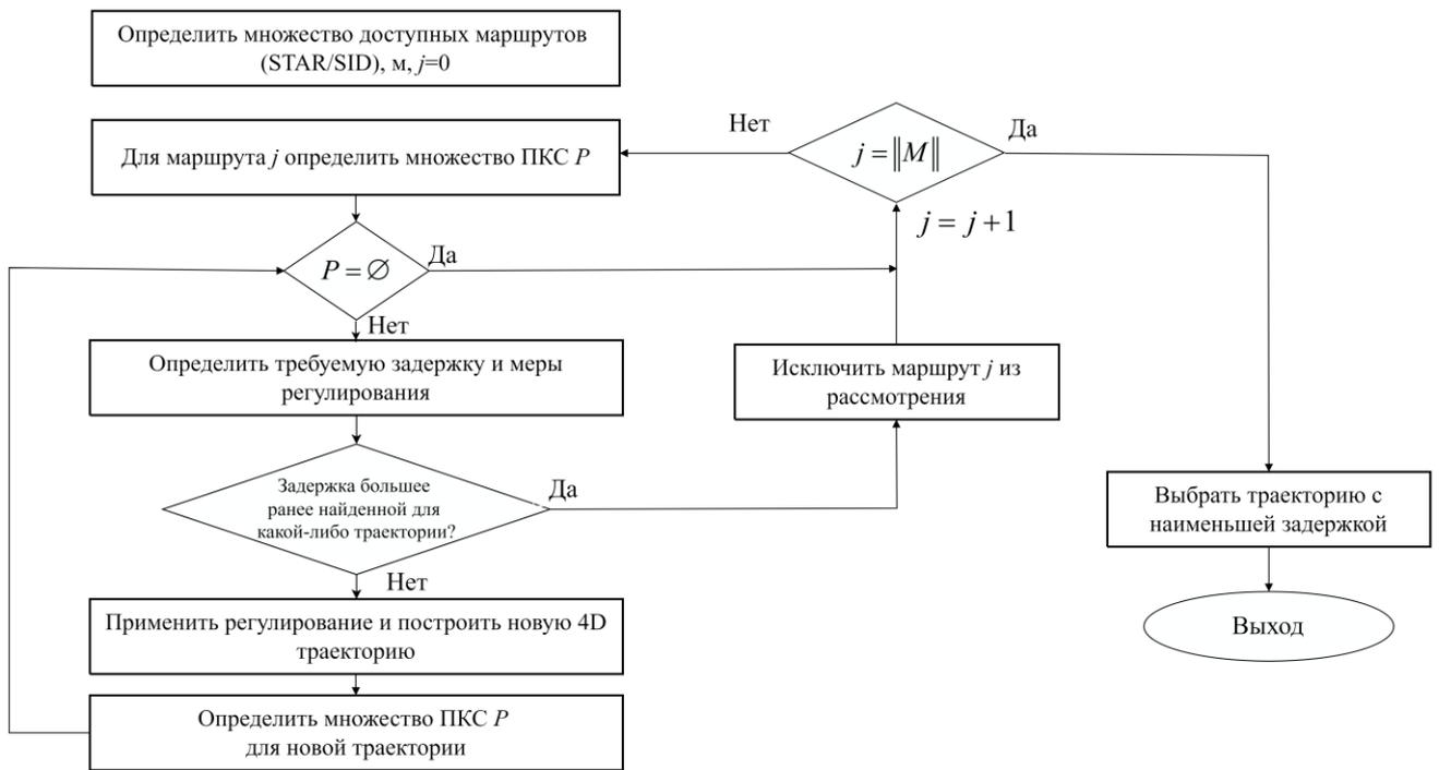
Рисунок 3.17. Алгоритм построения оптимальной бесконфликтной 4D траектории
