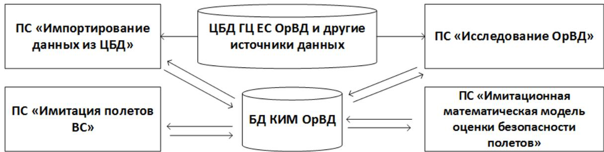
Рисунок 3.6. Структурная схема КИМ ОрВД
