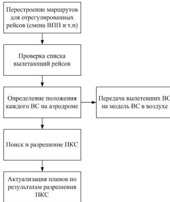
Рисунок 3.12. Блок-схема моделирования аэродрома
