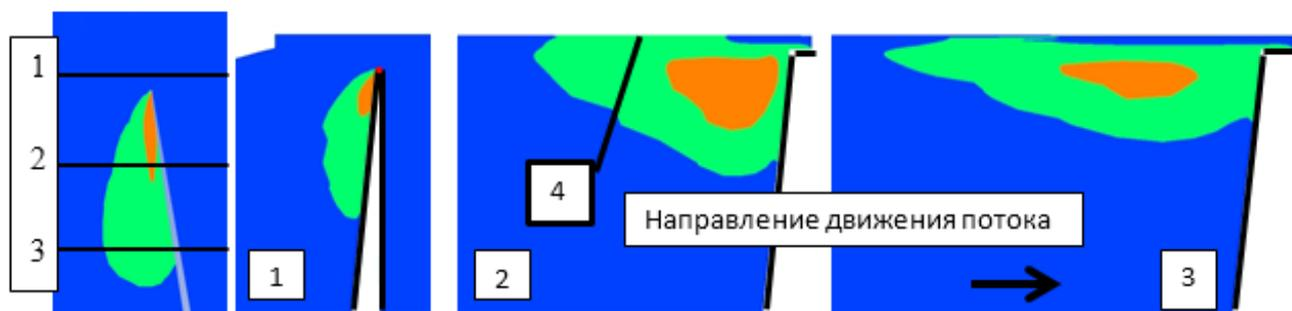
Рис. 4.2.6. Картина кавитации при больших давлениях на входе ( $\Delta h/n^2 \cdot 10^{-6}=1,54$ ). Левая картина – часть межлопаточного канала на периферии лопасти, остальные картины показаны сечениями (верхняя часть сечений корпус, нижняя поверхность этих сечений является межлопаточным каналом, а не втулкой, напорная сторона лопасти не показана). Цифрой 4 обозначена область замыкания каверны на корпусе.
