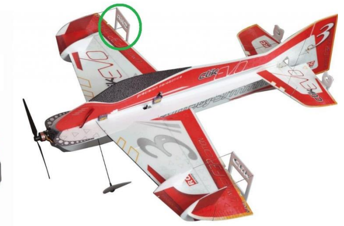
Рисунок 5.11 – Тормозные устройства для увеличения сопротивления ЛЛ
