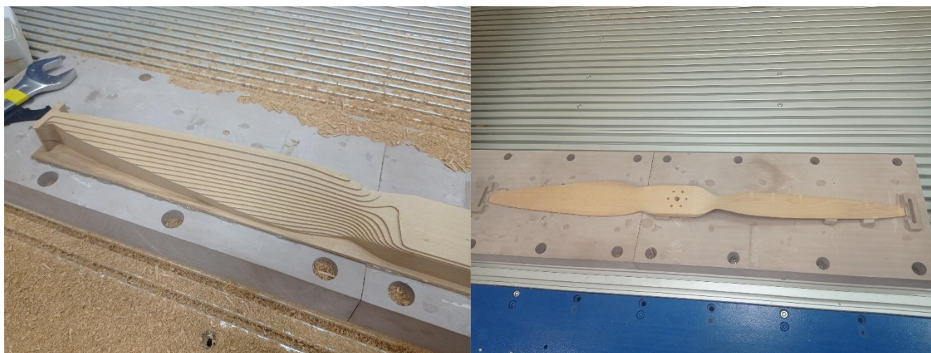
Рисунок 4.6 – Изготовление экспериментального винта ДПЛА методом фрезерования на станке с ЧПУ
