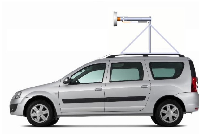
Рисунок 5.10 – Испытания воздушного винта на подвижном стенде
