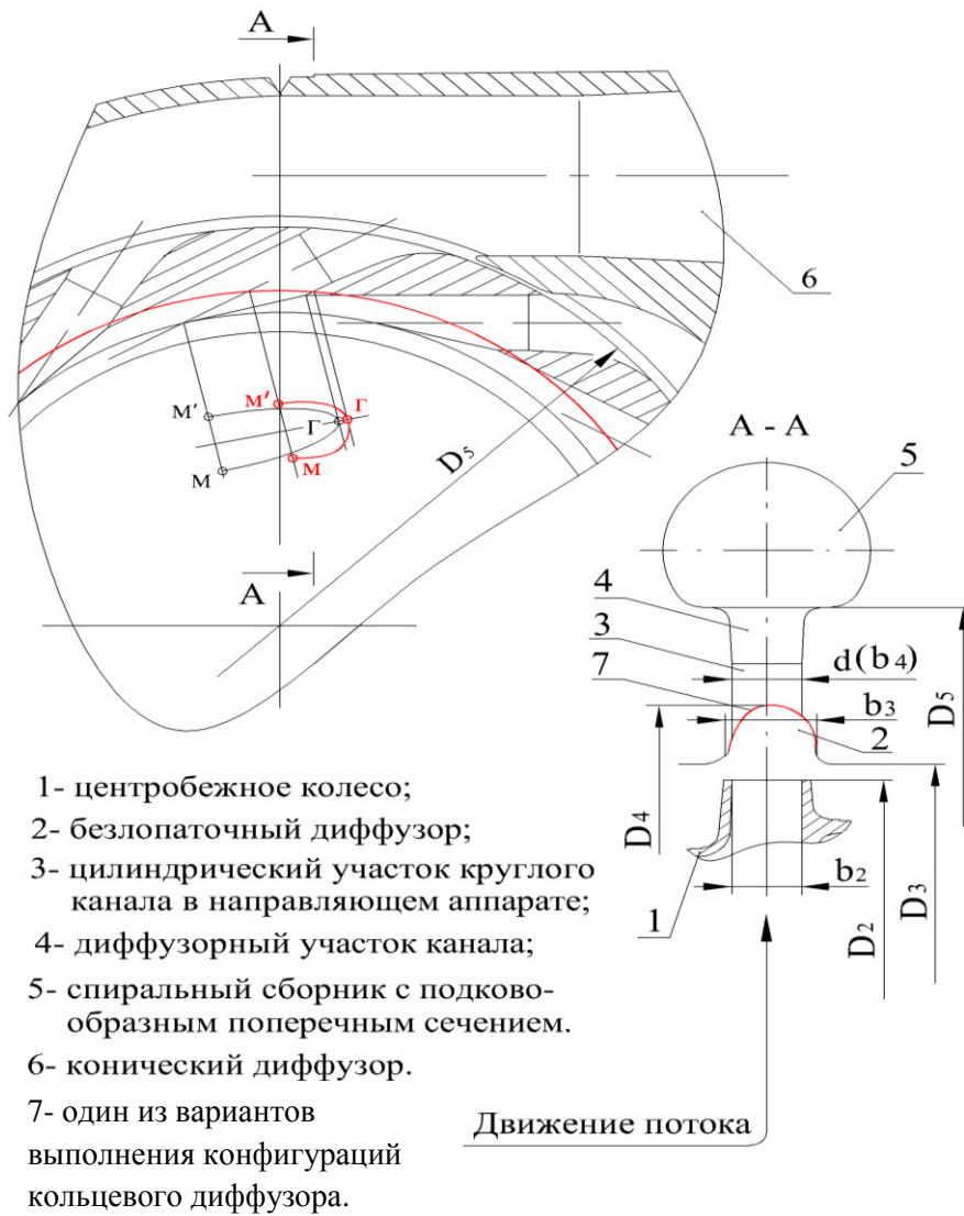
Рис.6. Геометрия кольцевого диффузора, обеспечивающего снижение нестационарности потока после рабочего колеса.
