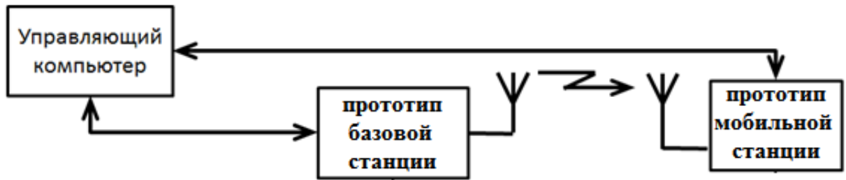
Рисунок 5.6 – Схема экспериментальной установки тестирования прототипов базовой и мобильной станций.
