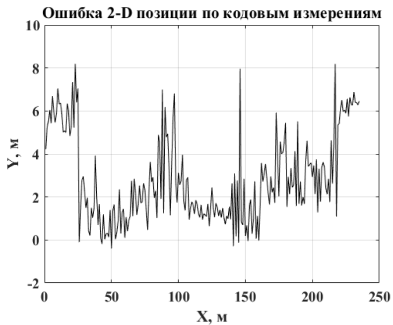
Рисунок 5.20 – Ошибка оценки 2-D позиции мобильной станции по кодовым измерениям.
