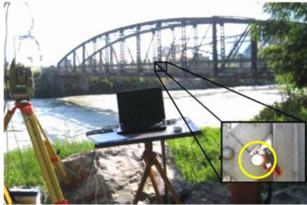
Рисунок 1.6 – Использование сенсора DAEDALUS для оценки колебаний моста.
