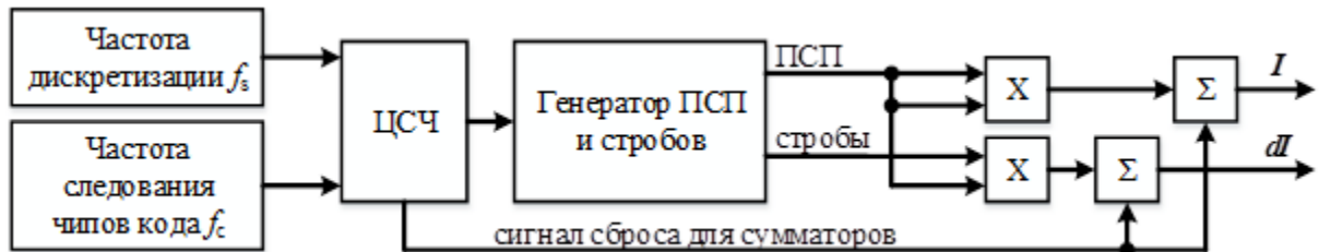
Рисунок 4.2 – Блок-схема имитационной модели MATLAB/Simulink.
