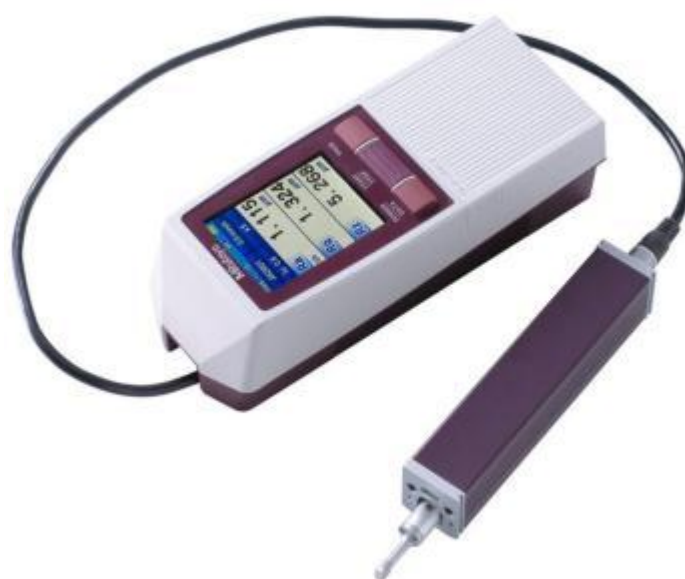
Рис.3.4 - Профилометр Mitutoyo SurftestSJ-210 .
