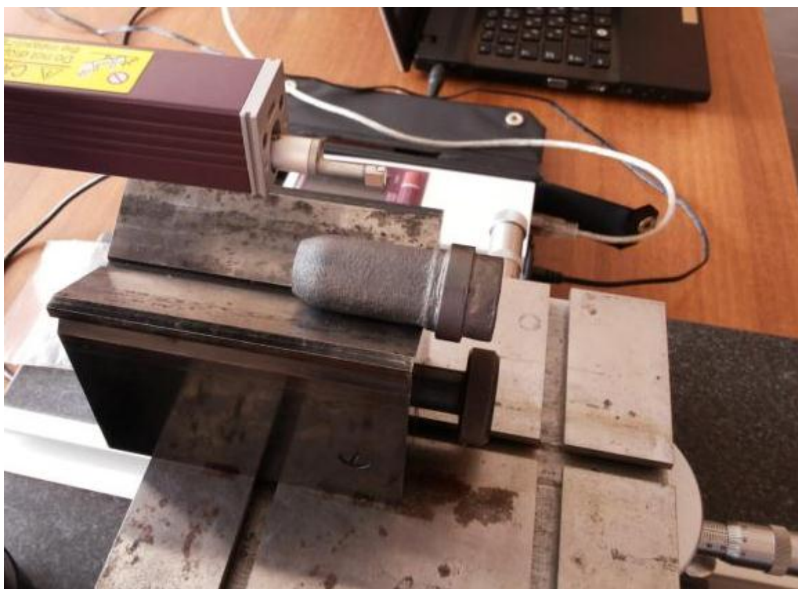
Рис.6.31. – Установка композитной камеры сгорания в клиновом держателе.
