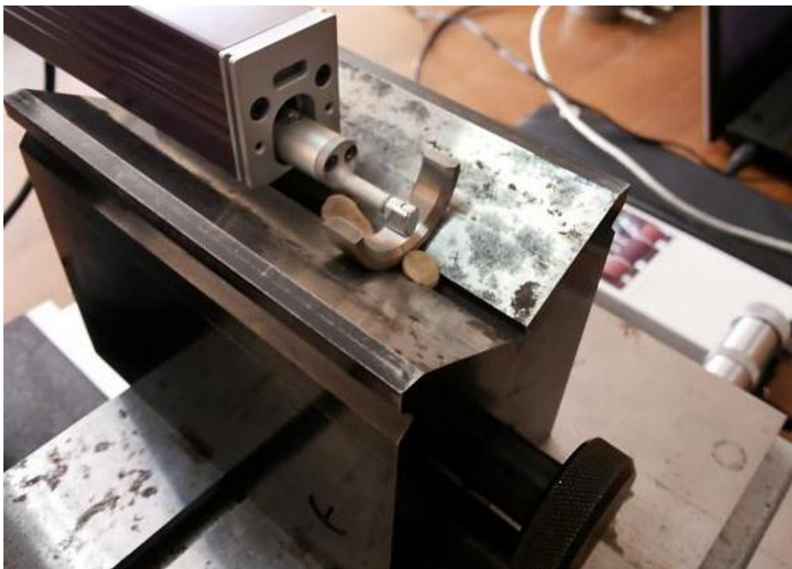
Рис.6.32. – Установка переходного кольца в клиновом держателе.
