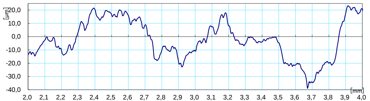
Рис.6.35. – Шероховатость камеры сгорания на интервале 2мм.
