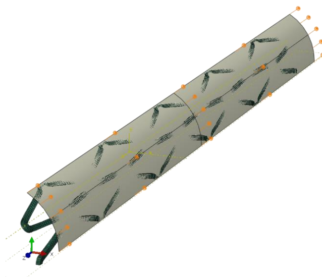
Рисунок 4.6 – Второй этап моделирования: Продольное перемещение ( U_3 = 15 мм) удерживающей оболочки. Раскрытие стента
