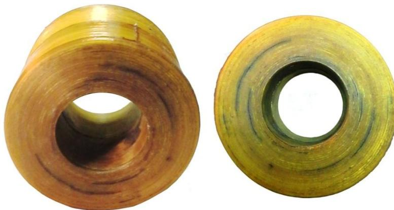
Рис. 1.3. Кольцевые трещины (расслаивание) в толстостенном намоточном цилиндре.
