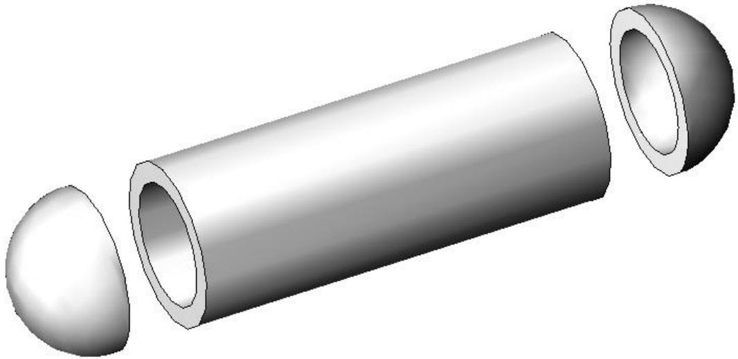
Рис. 3.1. Схема толстостенного кокона высокого давления с металлическими полусферическими заглушками по торцам.
