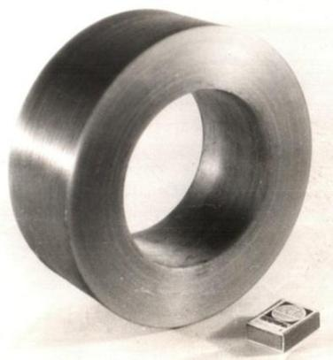
Рис. 1.9. Монолитный (без трещин) толстостенный однонаправленный намоточный цилиндр.
