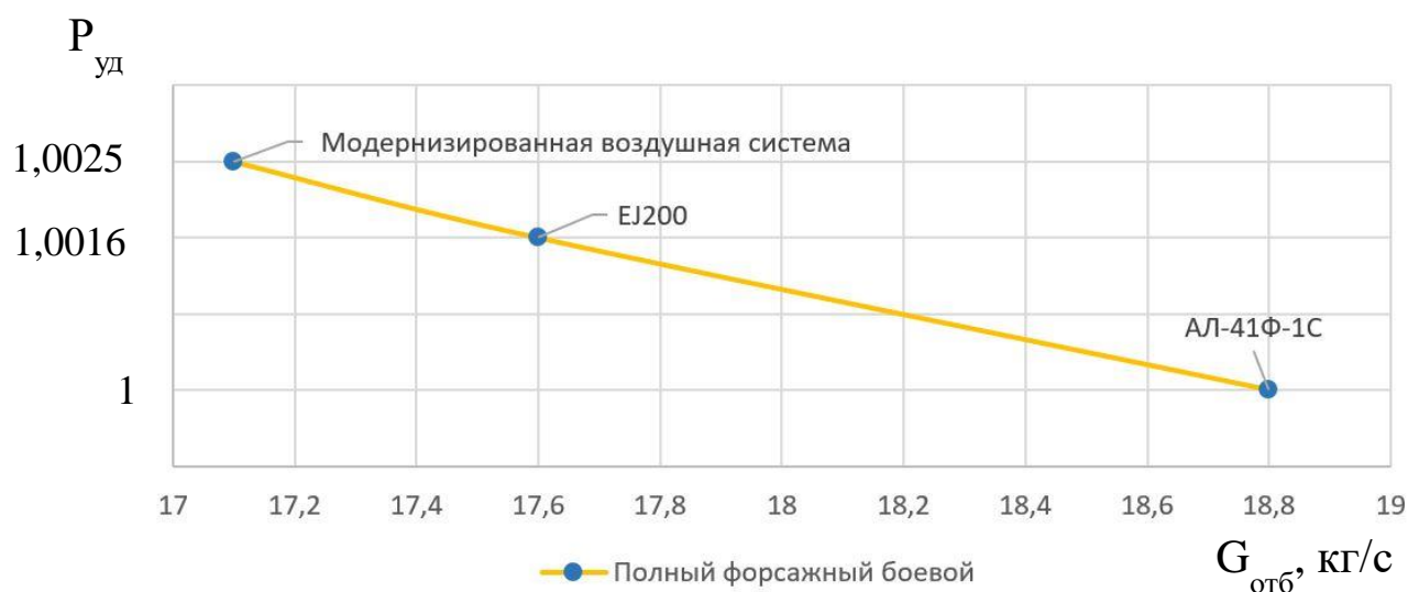
Рисунок 3.17 - Удельная тяга современных ТРДДф, отличающихся конструктивными схемами воздушной системы на полном форсажном боевом режиме
