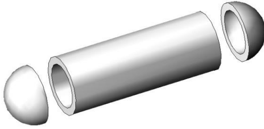
Рис. 7. Схема толстостенного кокона высокого давления с металлическими полусферическими заглушками по торцам.
