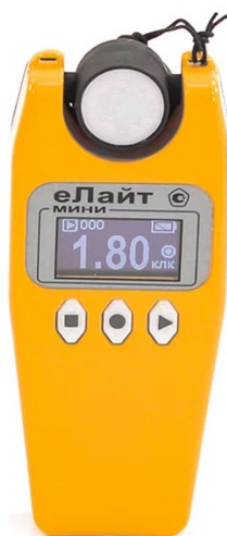
Рисунок 37 – Люксметр цифровой еЛайт-мини
