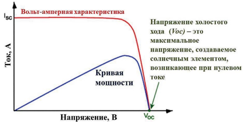
Рисунок 7 – Вольт-амперная характеристика солнечного элемента и напряжение холостого хода
