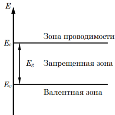
Рисунок 5 – Зонное строение полупроводника
