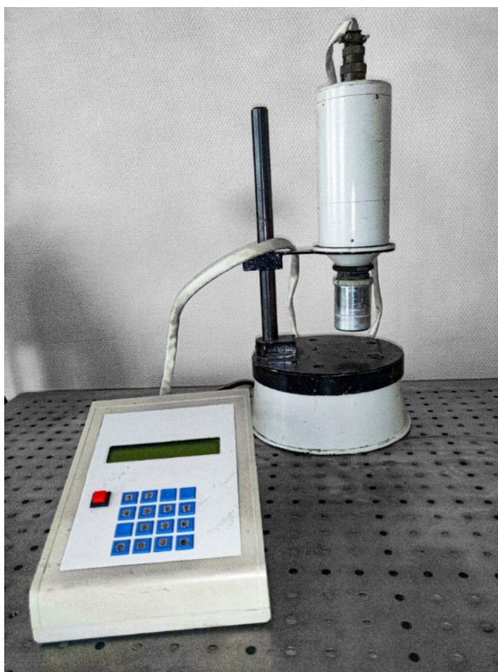
Рисунок 43 – Установка измерения обратного рассеяния лазерного излучения Установка ИОР состоит из оптического и электронного блоков.
