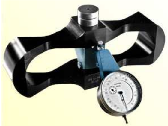
Рис. П4.6. Динамометр для измерения усилия сдвига трубы.
