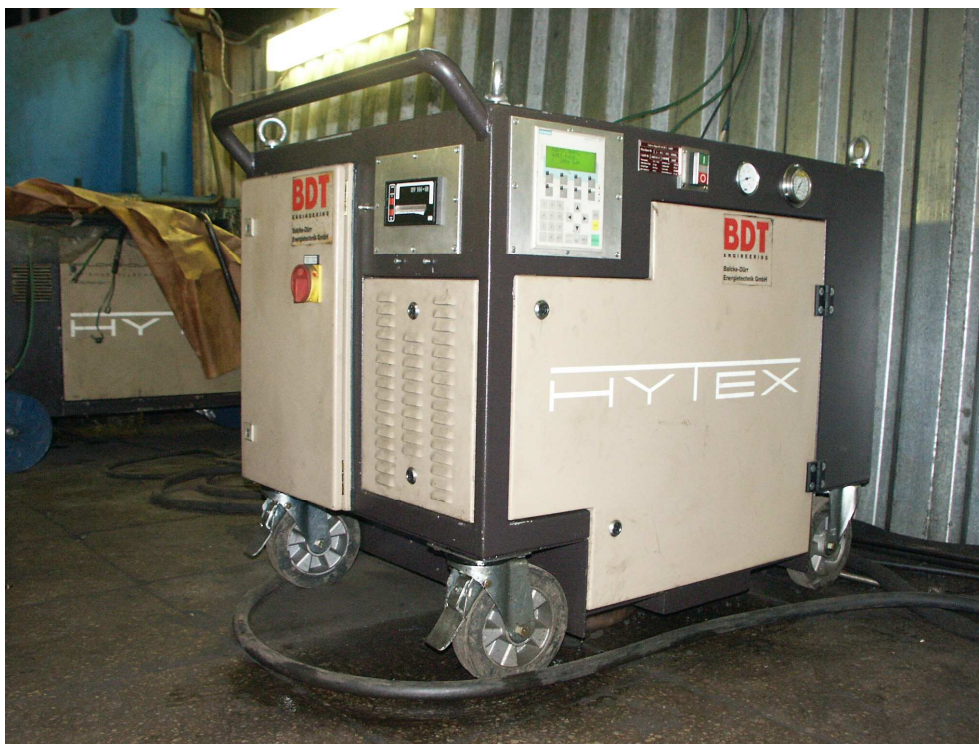
Рис.П5.5. Установка для гидравлической раздачи труб.
