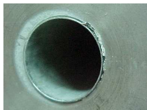
Рис. 1.9. Дефекты в сварном шве: а – некачественная сварка; б – щелевая коррозия
