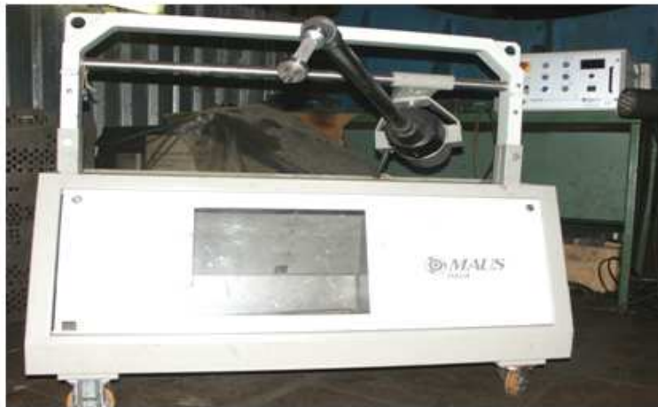
Рис. П1.5. Электрическая вальцовочная машина М4V фирмы "MAUS"(Италия)
