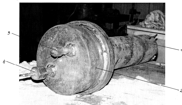
Рис.П5.10. Внешний вид модели ПВД-К: 1- модель; 2- камера; 3,4- штуцеры.
