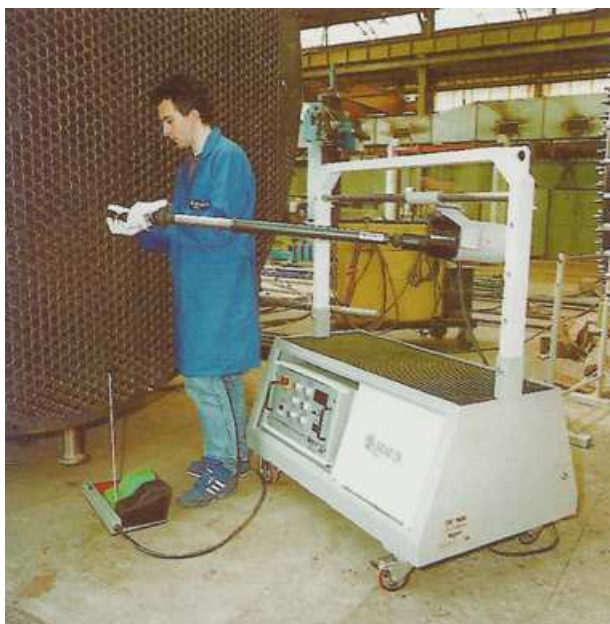
Рис. 1.12. Выполнение операции вальцевания с помощью привода M4V установки фирмы «MAUS», Италия (каталог фирмы «MAUS»).
