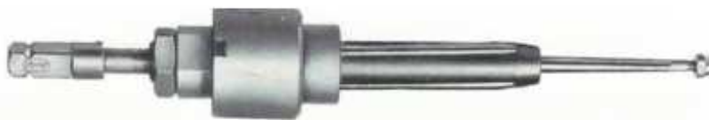
Рис. П1.1. Роликовые вальцовки: 1-ролик; 2- корпус; 3- веретено; 4- обойма; 5- подшипник упорный; 6- хвостовик (квадратный)
